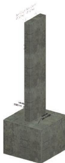
Stütze mit angeformtem Fundamentkörper
